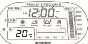
●次に「SET」ボタンを1回押すと時・分のセットが完了します。
