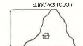
※ 本機には「高度の補正機能」がついています。できるだけ正しい高度計測を行う為に、登山などを開始する時に高度の補正を行ってください。
